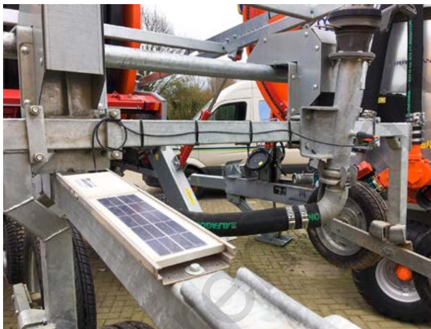
Installatie van een druksensor op een beregeningshaspel ter controle van de variabele afgifte.
