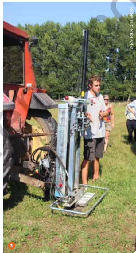
1 De snelheid waarmee het water uit de ringfilter doorsijpelt naar de bodem is een maat voor de doortatendheid en het vochtleverende vermogen van een bodem. 2 De bodemscanner gebruikt door Orbit (UGent) en Vandenborne kan de variabiliteit in de bodem in kaart brengen op 0,5, 1 en 1,5 tot 4 m diep. 3 Met de penetrologger kan men bodemstalen nemen en de bodemverdichting meten en vervolgens de resultaten daarvan op een kaart weergeven.
