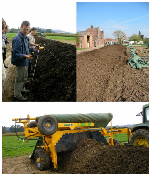
Figuur 13 Boerderijcompostering in rillen, met een voorbeeld van een compostkeerder die gehuurd kan worden via www.boerenlandschap.be .
