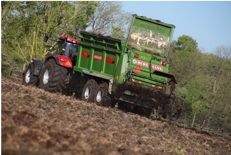
Figuur 11 Een meststrooier met horizontale freeswalsen en strooitafel zijn geschikt voor het verspreiden van dikke fractie (Koonstro Loon- en grondverzetbedrijf, 2018).
