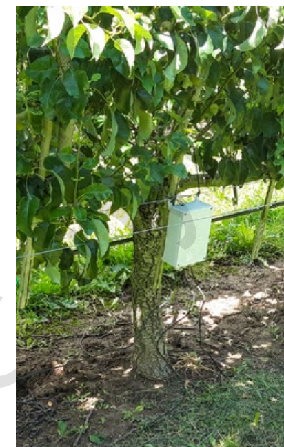
Bodemvochtsensoren meten continu het vochtgehalte in de bodem en zijn gekoppeld aan een Internet-of-Things-node die de data in realtime doorzendt naar een onlineplatform.
