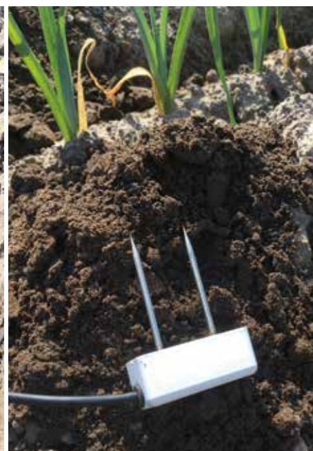
De TEROS 10-bodemvochtsensoren worden op 15 cm onder de plantbasis geïnstalleerd, hier op een prei-perceel.
