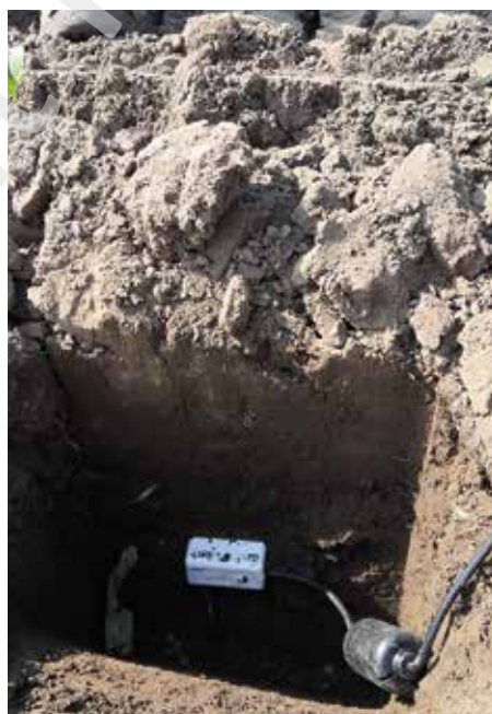
De TEROS 10-bodemvochtsensoren worden op 15 cm onder de plantbasis geïnstalleerd, hier op een prei-perceel.
