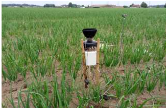
Figuur 1 Een communicatiemodule in een uienperceel waarbij neerslag wordt gemeten met een pluviometer en via een LPWAN netwerk wordt doorgezonden naar de BDB databank. De module is in dit geval ook verbonden met drie bodemsensoren die het vochtgehalte in de bodem meten.
