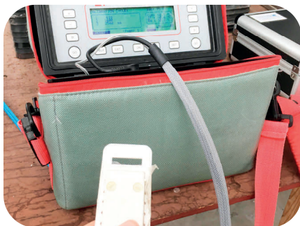
Kalibratie van de porometer met behulp van het kalibratieplaatje.
