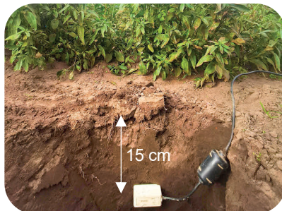
Installatie Teros 10 bodemsensor (Meter Group) in een profielput in de bodem.
