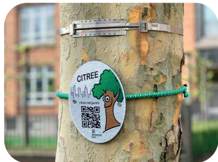
Links: Close-up banddendrometer. Rechts: De banddendrometer wordt rond de volledige stam van de boom angebracht. Bron: UGent.
