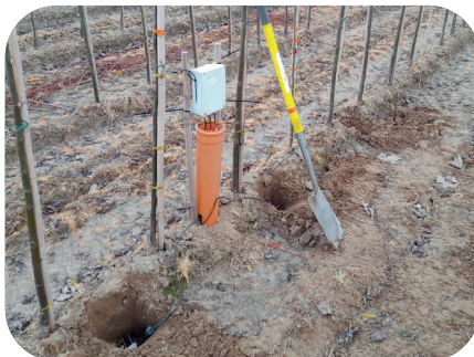
Installatie van bodemsensoren op het veld.
