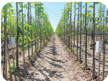
Dataloggers in een laanbomenperceel bij Boomkwekerij Weymeersch te Wetteren. Sensordata is via een cloud-netwerk beschikbaar vanop afstand.
