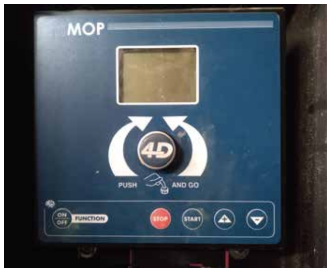
Na installatie van de IrriMOP-module op de haspel kan je via de app op een eenvoudige manier de beregeningsinstallatie controleren en sturen.
