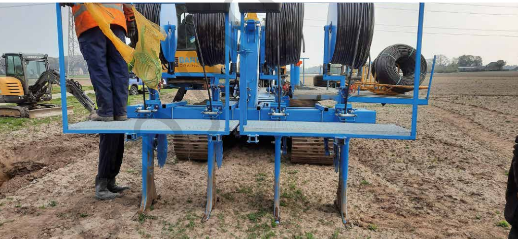
De omgebouwde drainagemachine legt druppelslangen voor meerdere jaren op 40 cm diepte in de grond.
