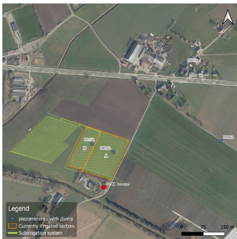
Figuur 28: Locatie van de peilbuizen op en in de omgeving van de zone met subirrigatie waarop de tijdreeksanalyse uitgevoerd wordt
