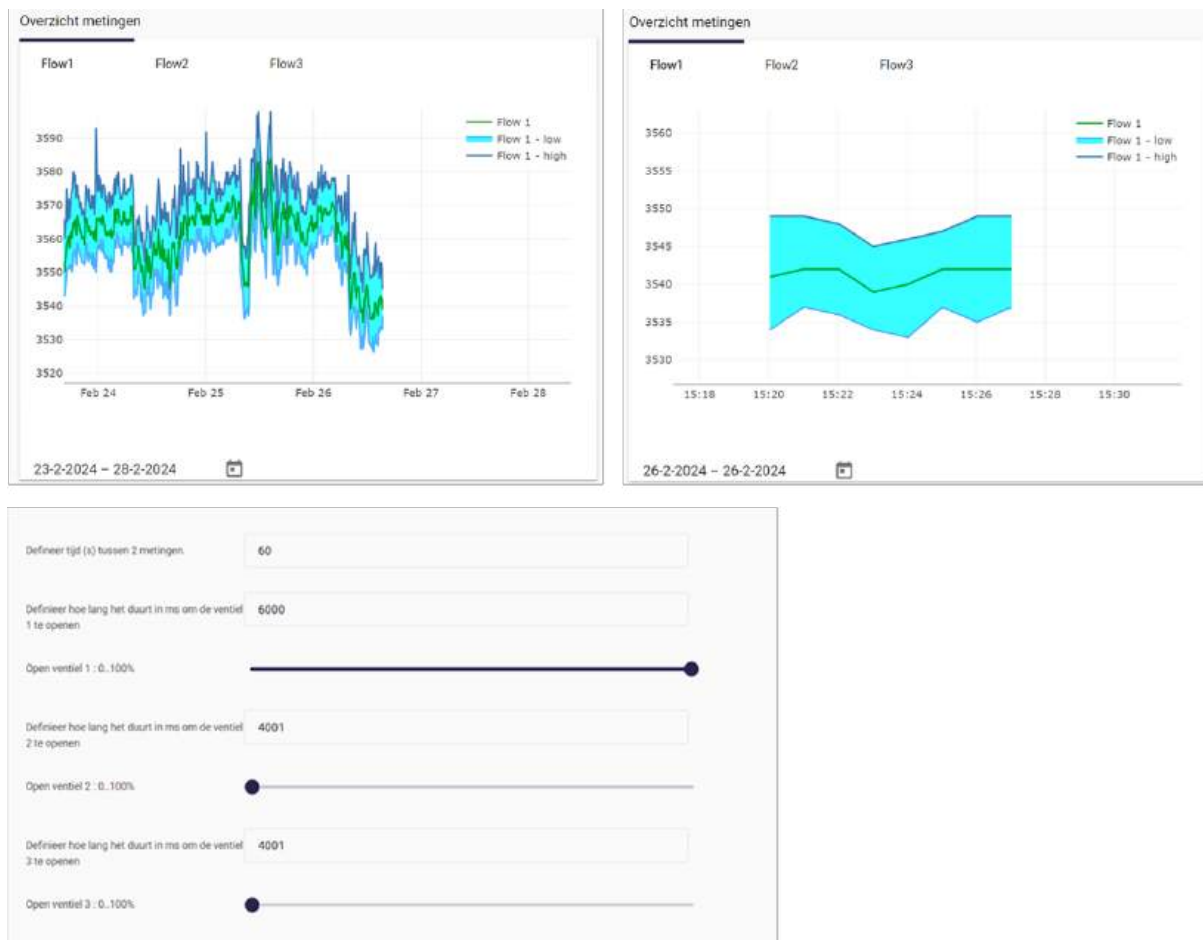
Figuur 40: Illustratie van het online dashboard. Boven: meting van het instroomdebiet van Blok A op twee tijdstippen; onder: aansturing van de vlinderkleppen voor Blok A ('Ventiel 1') en Blok B ('Ventiel 2').
