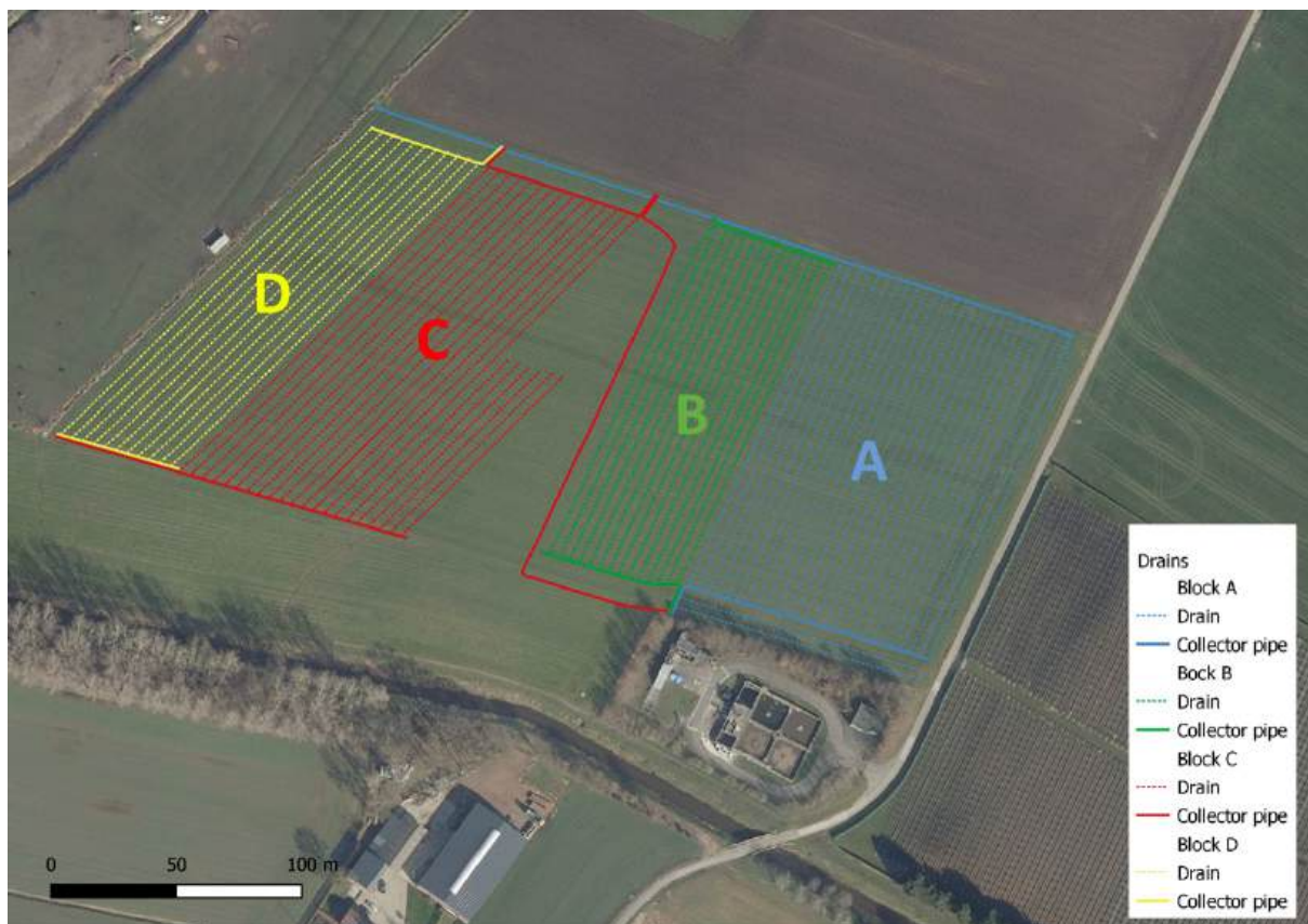
Figuur 6: Finale ligging van het buizen netwerk van het subirrigatiesysteem. Volle lijnen betreffen de waterdichte ('blinde') verzamelbuizen, en stippellijnen de geperforeerde waterdoorlatende buizen.
