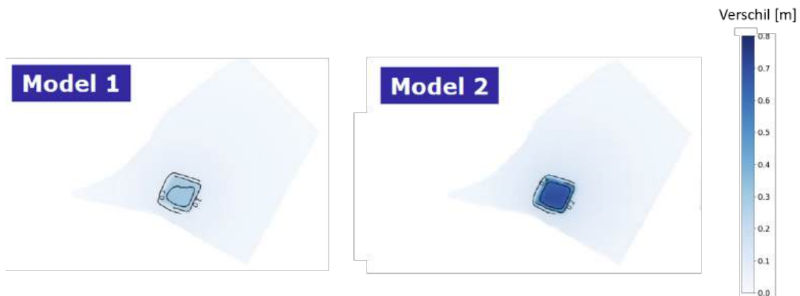
Figuur 33: Toename in grondwaterpeil (in meter) door de subirrigatie, volgens 2 modelversies
