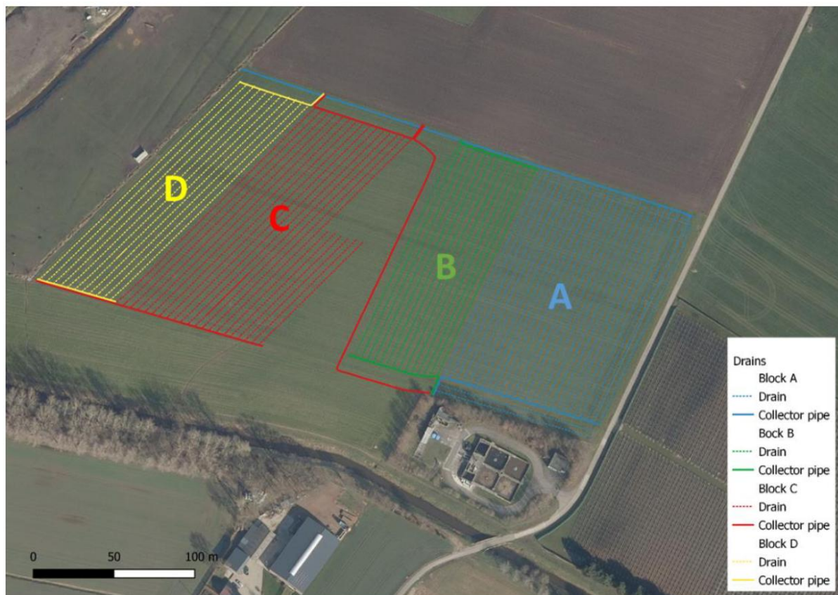
Figuur 2: Het subirrigatiesysteem, opgedeeld in de 4 blokken A, B, C en D. Volle lijnen betreffen de 'blinde' verzamelbuizen, die het water geleiden naar de waterdoorlatende drainagebuizen, aangeduid als stippellijnen op de figuur.
