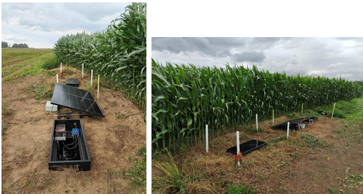
Figuur 15: Zonnepaneel en monitoringsputten voor overflow A en B en inlaatpunt D
