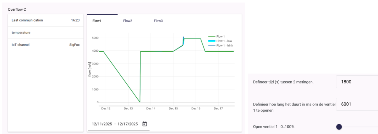
Figuur 17: Visualisatie van de debietsensor in de nieuwe monitoringsput (links) en interface of de actuator in de nieuwe put aan te sturen
