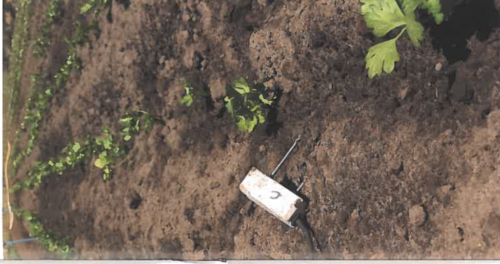
We installeerden de sensoren steeds op 15-20 cm diepte.
