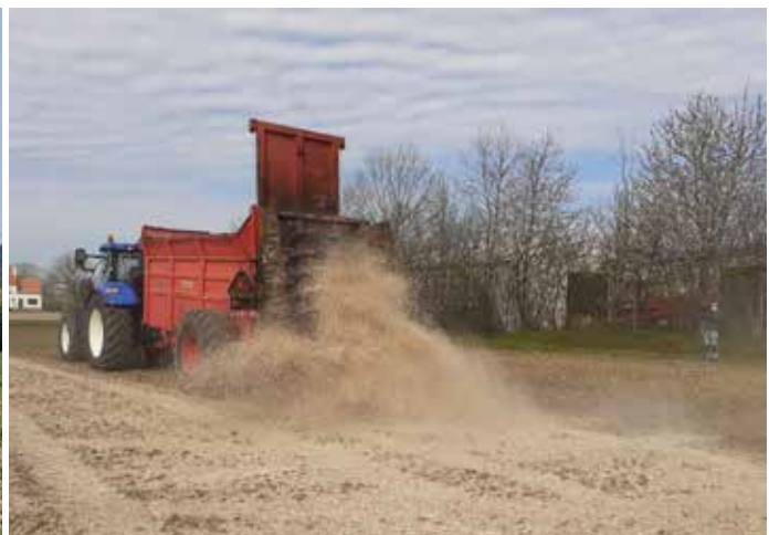
Een stalmeststrooier met verticale walsen rijdt de gft-compost (links) en de miscanthussnippers (rechts) uit tijdens het demonstratiemoment in Herent.
